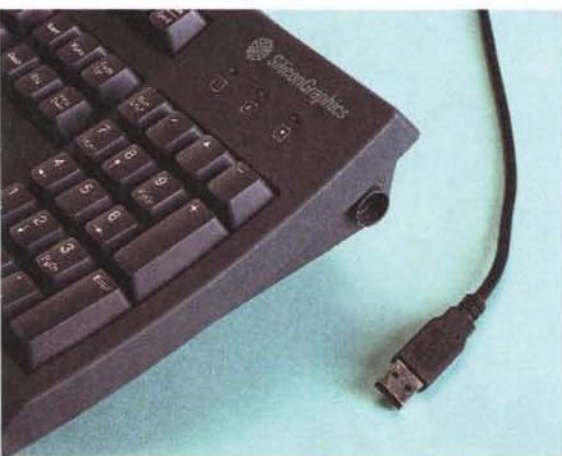
Particolare della tastiera, provvista di connettore USB e di adattatore PS/2 per il mouse.
